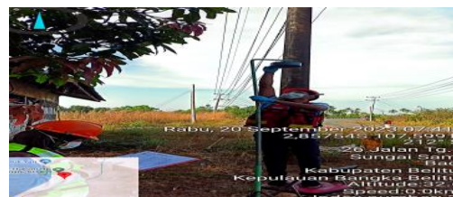
Pengujian kualitas udara dengan metode passive sampler di Kawasan Pemukiman Kantor Desa Aik Pelempang Jaya
