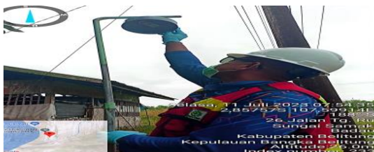
Pengujian kualitas udara dengan metode passive sampler di Kawasan Pemukiman Kantor Desa Aik Pelempang Jaya
