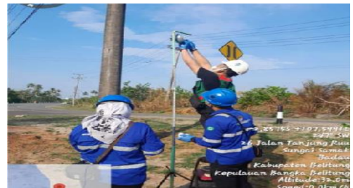
Pengujian kualitas udara dengan metode passive sampler Kawasan Industri Suge
